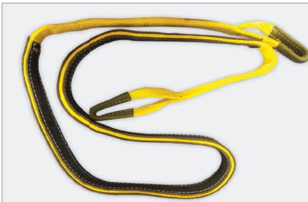
Eslingas sintéticas con ojos invertidos. Se fabrican con un recubrimiento especial de cuero, se utilizan generalmente para trabajo pesado ya que son más duraderas que los demás modelos también se utilizan cuando las cargas presentan esquinas filosas.
